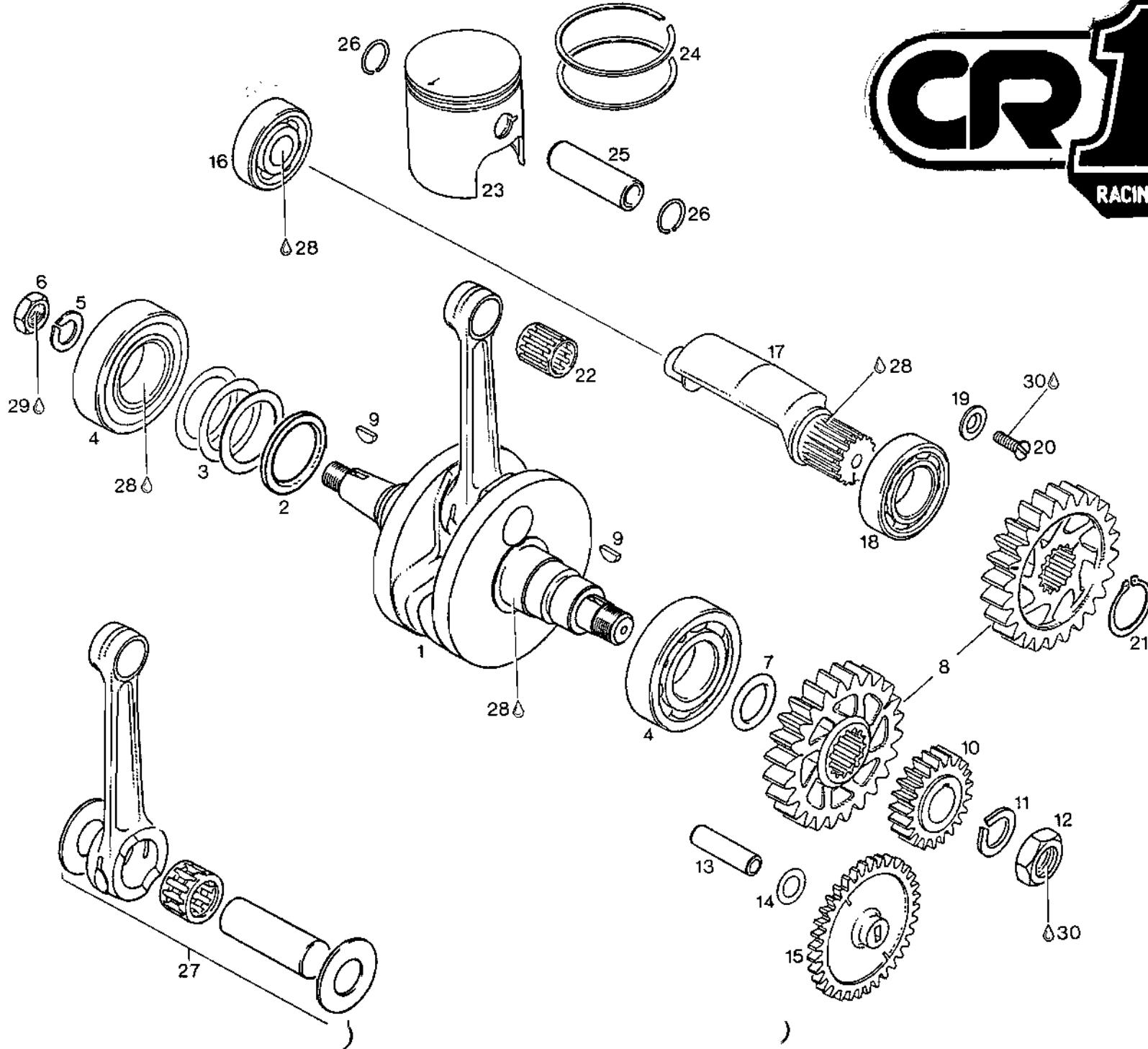
KURBELWELLE, AUSGLEICHSTRIEB, KOLBEN
