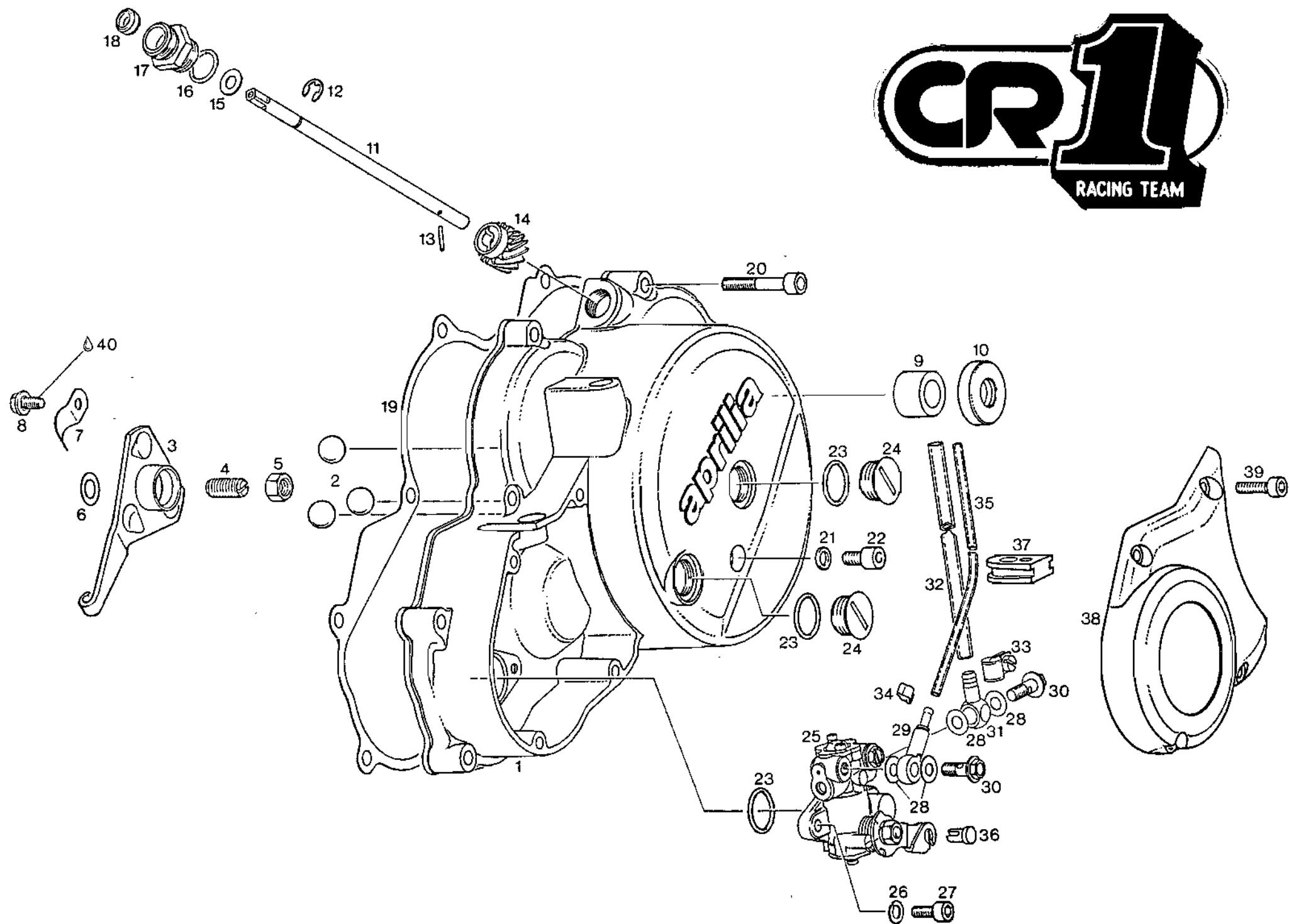
KUPPLUNGSDECKEL, MECH. DREHZAehler, OELPUMPE
